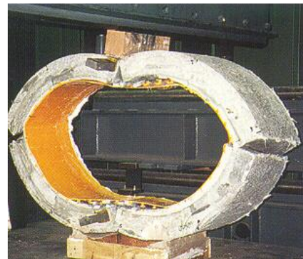
Figure 14. Test d'écrasement - vue de côté
