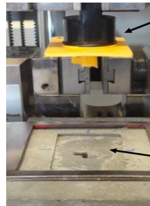
Figure 6. Tests de sous-pression plaque à crampons /béton Figure 7. Test d'arrachement
