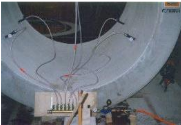
Figure 6. Tests de sous-pression plaque à crampons /béton Figure 7. Test d'arrachement
